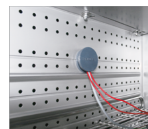
Foro di accesso con tappo in silicone
